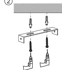
1.Montera fästet i taket med hjälp av plug och skruv.
